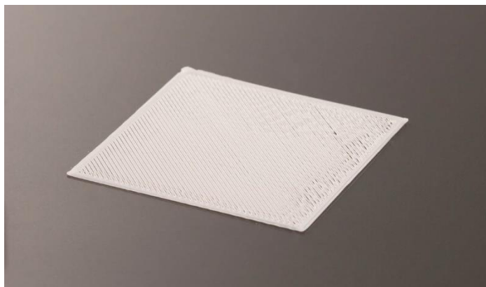
Rys. 54 Przykład zbyt niskiego ustawienia stołu roboczego
