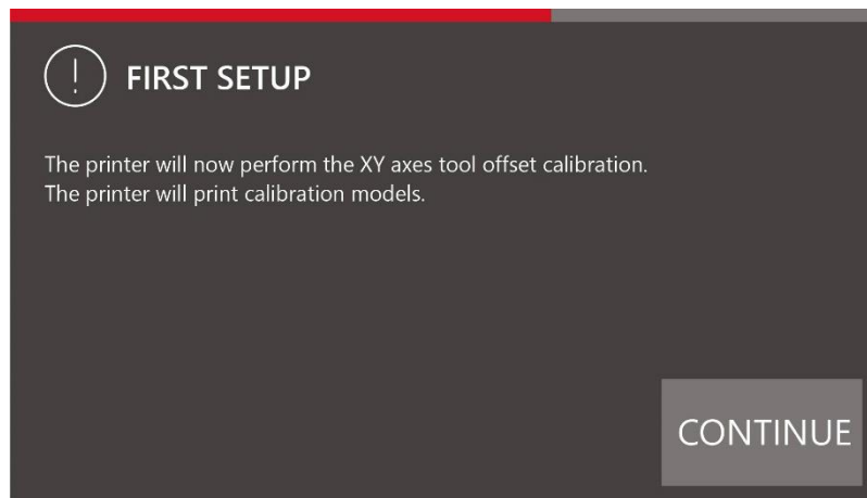
Rys.42 Ekran pierwsze uruchomienie kalibracja offsetów w osi X, Y
