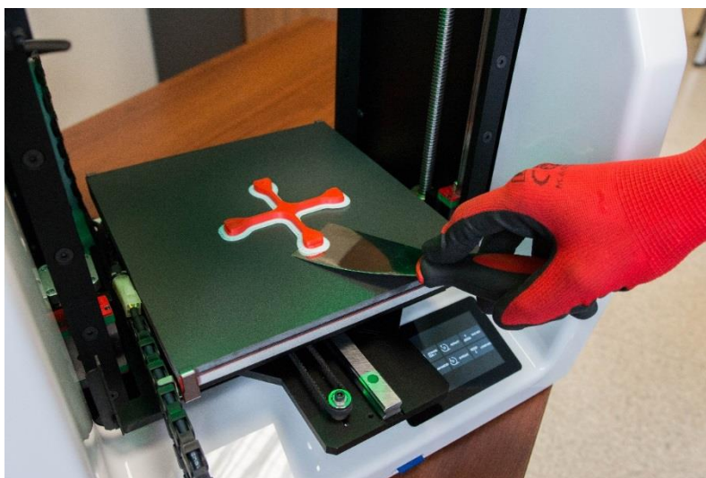
Rys. 55 Prawidłowe postępowanie przy zdejmowaniu modelu z drukarki
